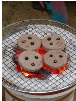
③鋳型に砥の粉を塗りカルカヤ草をセットし管玉を再度熱すると角が丸くなってくる
